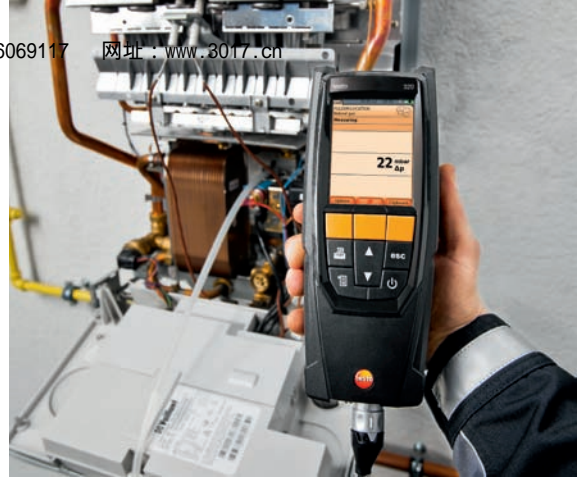
所需附件：软管连接组件，用于单独测量气体压力， 订货号 0554 1203
