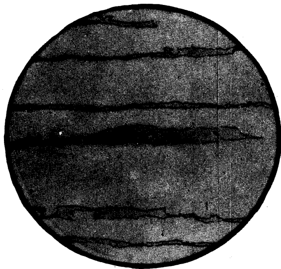
图 A4 2.0 级 \alpha -相面积含量 >8\% \sim 12\%
