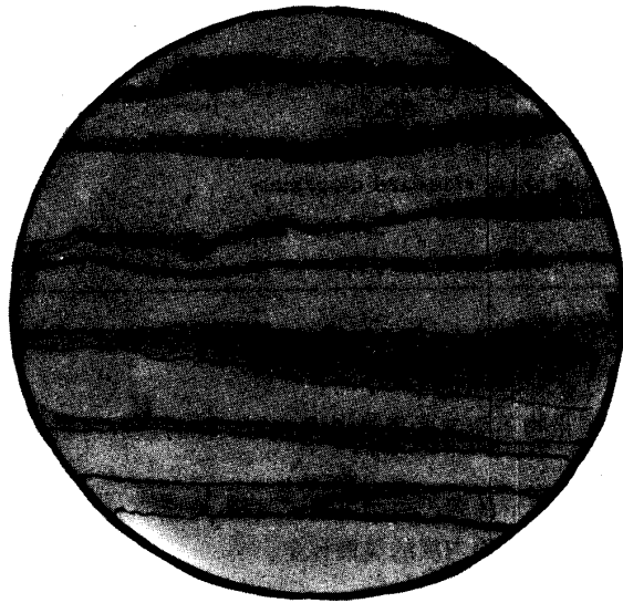
图 A6 4.0 级 \alpha -相面积含量 >20\% \sim 35\%
