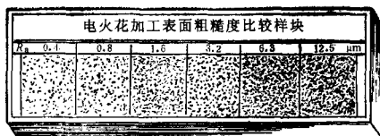
图2 电铸工艺复制的样块
